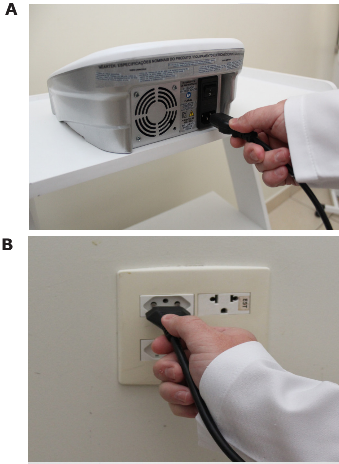
Figura 17. A e B, conexão do cabo de alimentação elétrica no equipamento e na rede elétrica.
