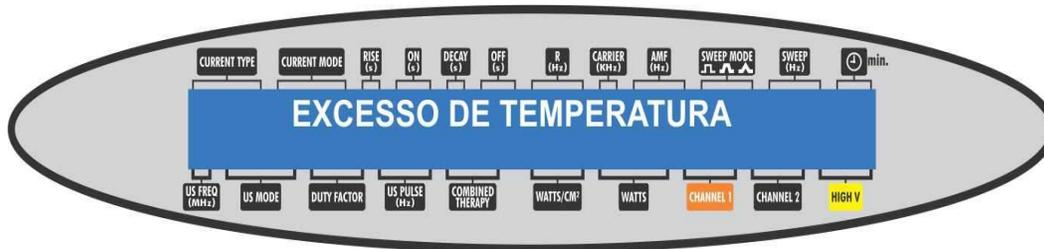
**Figura 2.** Visor de cristal líquido com mensagem de excesso de temperatura.
