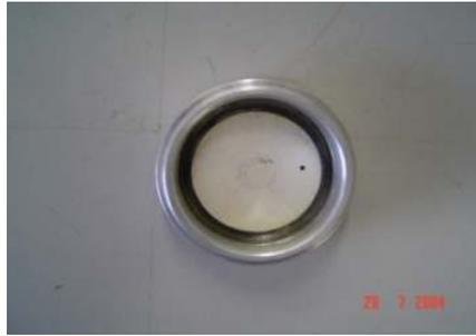
**Figura 1.** Cristal piezoelétrico inserido na retroface de um transdutor de ultrassom terapêutico.
