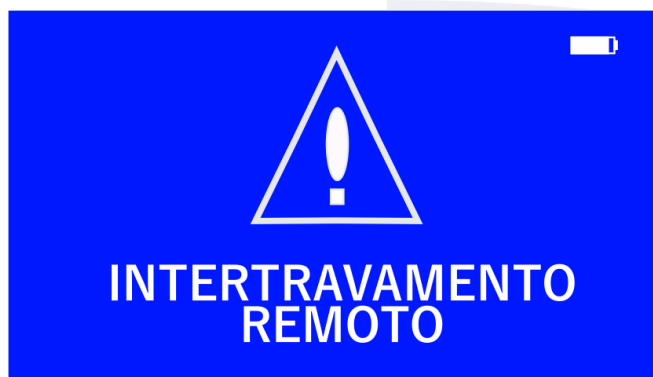
Imagem 47. Tela de intertravamento remoto acionado.
