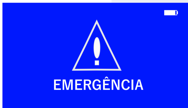
Imagem 45. Tela de botoeira de emergência acionada.
