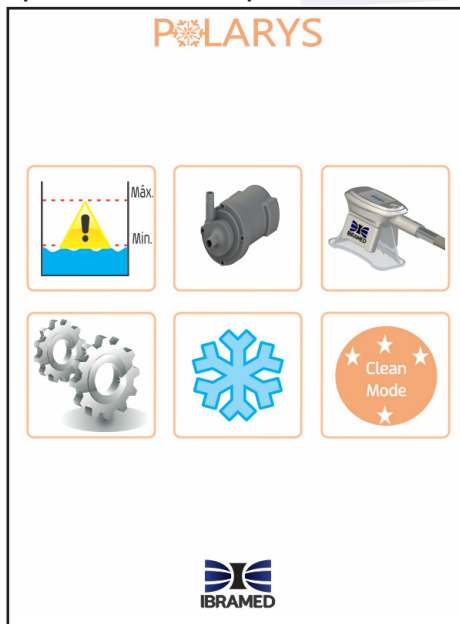
Imagem 39. Aviso de baixo nível de água no reservatório.
