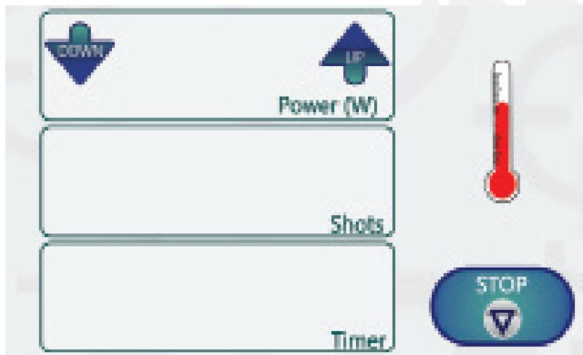
**Figura 10.** Aviso de excesso de temperatura.
