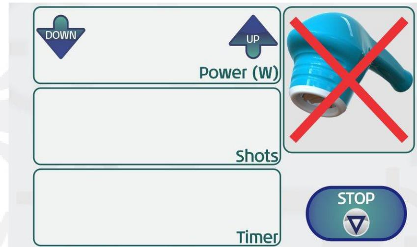
**Figura 11.** Aviso de equipamento sem transdutor.
